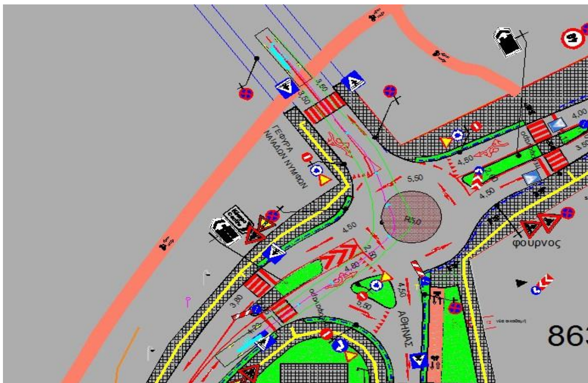
Σχήμα 5. (Αστικό Λεωφορείο 12,00μ) αριστερή στροφή από την οδό Τσόγκα προς την οδό Αθηνάς
