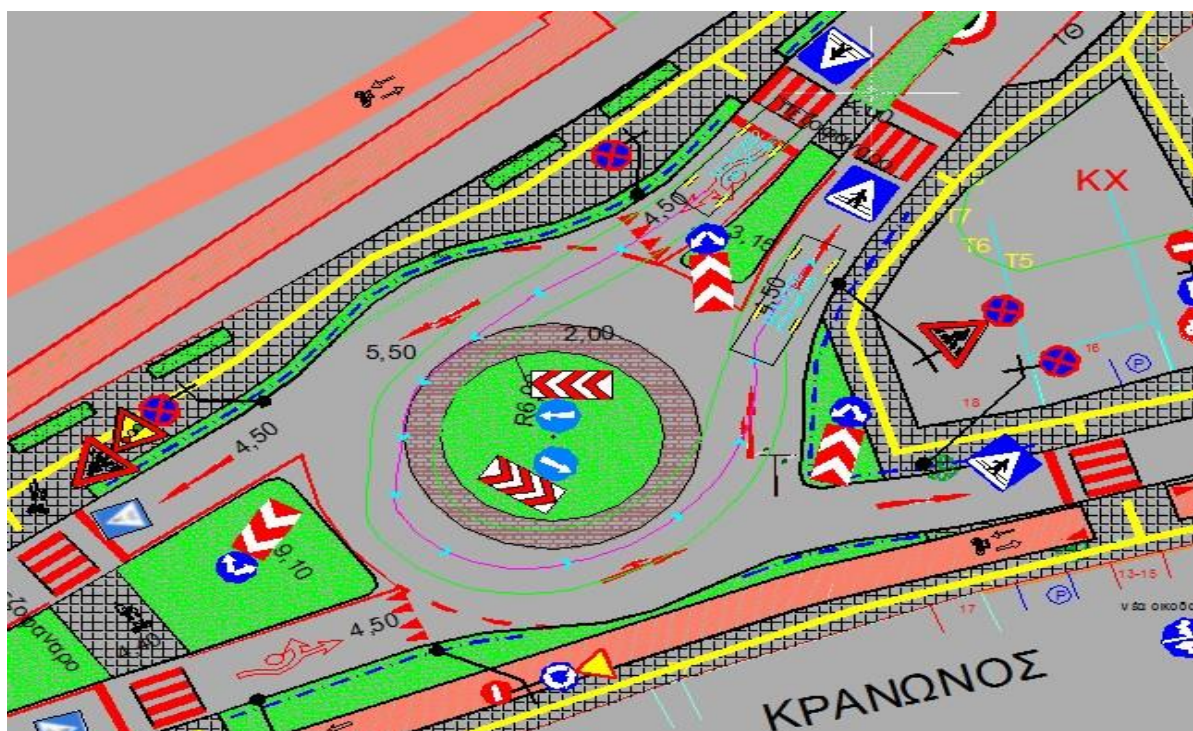
Σχήμα 2. (Αστικό Λεωφορείο 12,00μ) ευθεία κίνηση από οδό Τσόγκα προς την οδό Τσόγκα
