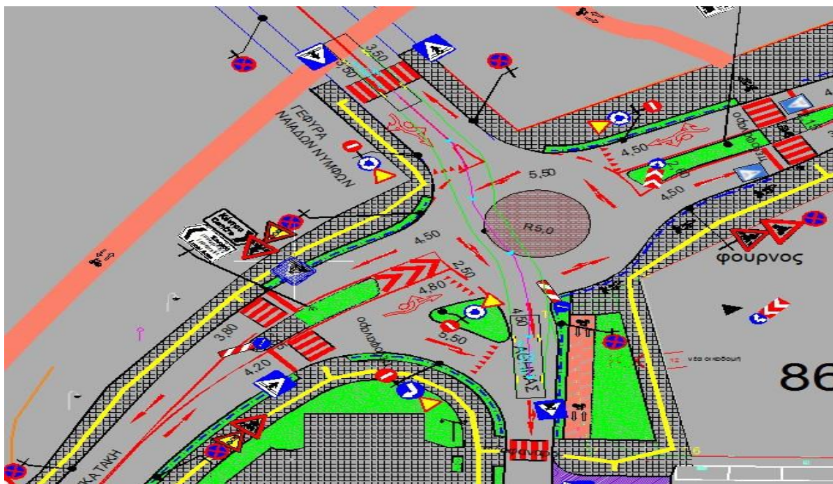
Σχήμα 3. (Αστικό Λεωφορείο 12,00μ) Κίνηση από Τσόγκα προς την οδό Τσόγκα
