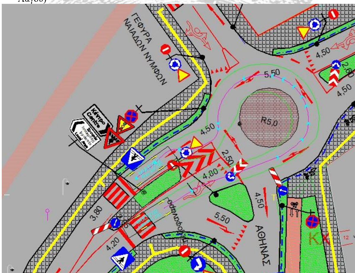
Σχήμα 2. (Αστικό Λεωφορείο 12,00μ) Κίνηση από Γέφυρα Ναιάδων Νυμφών προς την οδό Αθηνάς
