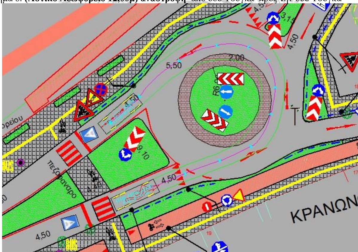
Σχήμα 6. (Αστικό Λεωφορείο 12,00μ) αναστροφή από οδό Τσόγκα προς την οδό Τσόγκα
