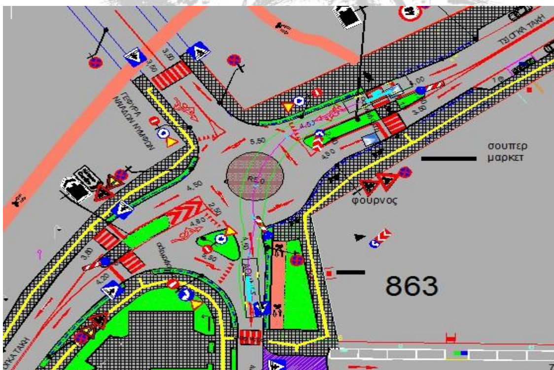
Σχήμα 6. (Αστικό Λεωφορείο 12,00μ) δεξιά στροφή από την Γέφυρα Ναιάδων Νυμφών προς την οδό Τσόγκα
