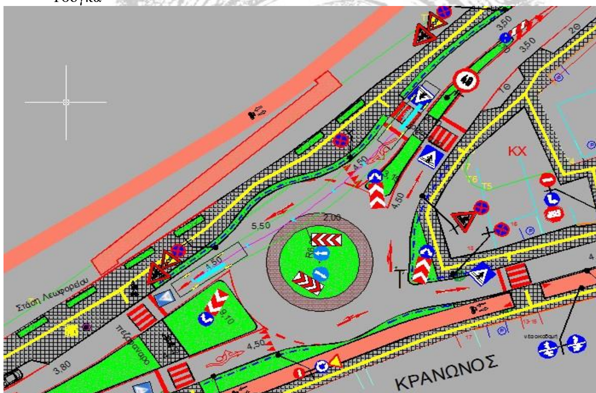
Σχήμα 3. (Αστικό Λεωφορείο 12,00μ) ευθεία κίνηση από οδό Τσόγκα προς την οδό Τσόγκα
