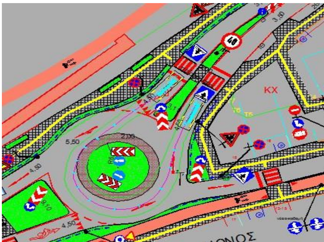
Σχήμα 6. (Αστικό Λεωφορείο 12,00μ) αναστροφή από οδό Τσόγκα προς την οδό Τσόγκα
